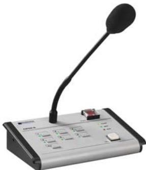
Eine perfekte Ergänzung zur Kleinzentrale Z-6 stellt die modern gestaltete mikroprozessorgesteuerte Tischsprechstelle DPM-6 dar. In das einbaufähige Tischgehäuse wurde ein Schwanenhalsmikrofon mit Superniere, sechs Linien-Taster, ALL-CALL, abgedeckte Alarm-Taste, Master/Slave-Funktion, Vorgong, Mikrofonvorverstärker (+6 dB) mit Symmetrierstufe integriert.
