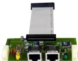
Die Remote-Card **MSP-6** dient als optionales Modul zum Einbau in die Z-6 Kleinzentrale (auf der Rückseite). Mit der MSP-6 lassen sich bis zu 10 Tischsprechstellen vom Typ DPM-6 anschließen, Kabellänge bis zu 500 mtr. Anschluß: RJ 45, 8-adrig.
