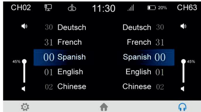
Die Sprechstelle kann zwei Dolmetscherkanäle für zwei Benutzer gleichzeitig auswählen. Auf jeder Seite des Geräts befindet sich ein 3,5-mm-Kopfhöreranschluss, so dass Sie zwei verschiedene Sprachkanäle auf einer Schnittstelle hören können. Im obigen Beispiel wurden die Sprachkanäle CH02 (links) und CH63 (rechts) ausgewählt.
