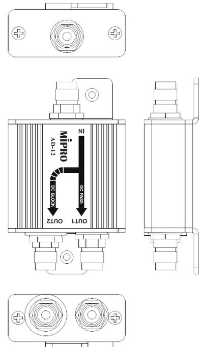
Mit dem passiven 2-Kanal Antennen-Combiner / -Splitter AD 12 (2 in 1) können bis zu zwei Sendeeinheiten über eine einzelne Sendeantenne betrieben werden (Einsatz bei In-Ear Systemen). Dadurch werden Intermodulationsverzerrungen, „Rauschen“ und Signalaussetzer reduziert. Der AD-12 kann auch invers als Antennensplitter genutzt werden um mit einer Empfangsantenne zwei Empfängereingänge zu speisen.
